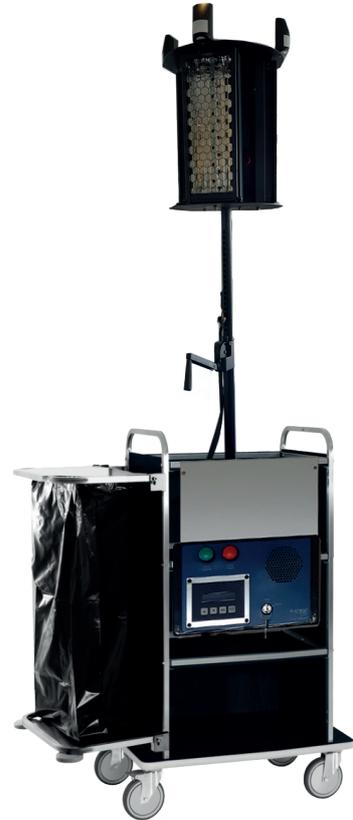
L' équipement nécessite une tension de 220V et chaque projecteur UV-C fournit une puissance de diffusion de 72W. L'utilisation doit impérativement être effectuée hors présence humaine dans la zone à décontaminer (par exemple lors de la fermeture de l'établissement ou la nuit). Le branchement est effectué sur le module de contrôle situé en partie basse du module de contrôle.
