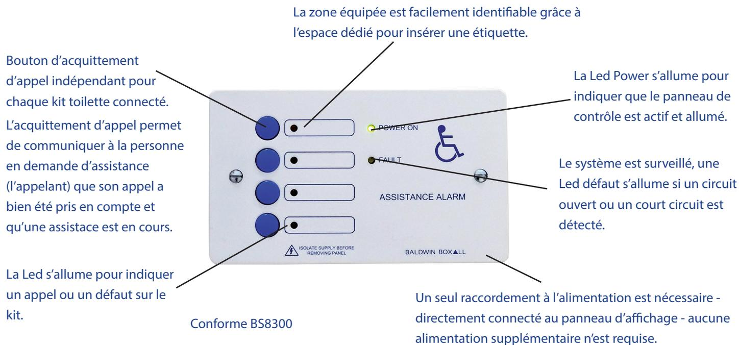
Dimensions du panneau de contrôle : 146 mm (l) x 86 mm (h).
